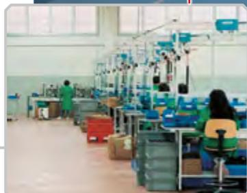
Chariots coulissants sur profilé d'aluminium permettant d'intégrer le support et l'alimentation ergonomique des appareils pneumatiques et électriques. Gamme MTS et ATS.
