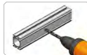
Le diamètre maximum de perçage et d'ébavurage ne doit pas être supérieur à celui conseillé dans le tableau.
