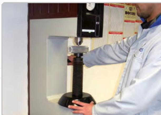
Nous avons mis sur pied un programme de contrôle et d'étalonnage préventif des instruments avec des procédures écrites comprenant les modes et fréquences d'étalonnage de tous les instruments et dispositifs contribuant à la sécurité et à la qualité des produits réalisés.
