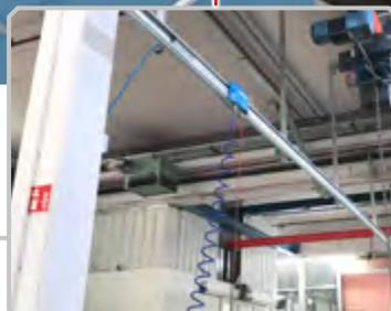
Lignes de montage réalisées avec HBS et chariots coulissants permettant d'intégrer le support et l'alimentation des câbles pneumatiques, électriques et de données. Gamme MTS.
