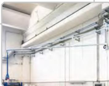
Bras pivotants d'établi en aluminium anodisé pour le support des outils pneumatiques. Gamme SAB.
