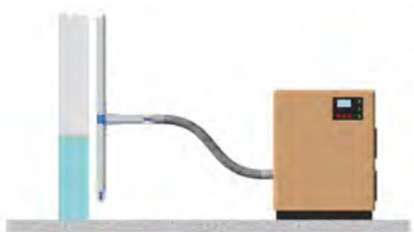
Il est conseillé de raccorder le compresseur ou tout autre appareil au moyen d'un raccord flexible afin d'amortir les vibrations de la machine.
