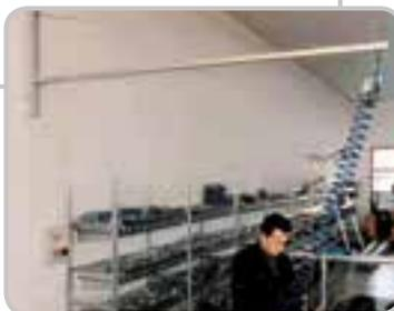
Настольные поворотные стрелы из анодированного алюминия для поддержки пневматических инструментов.
