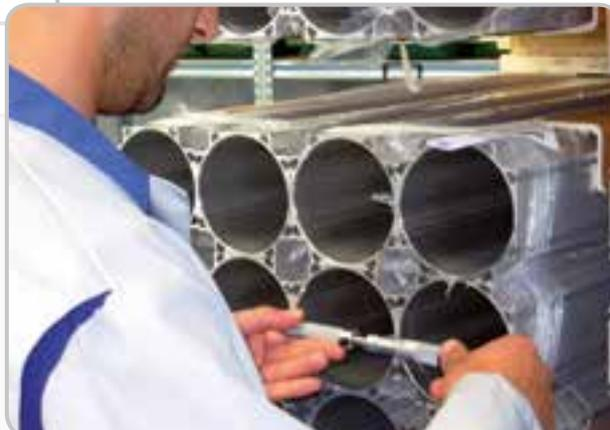
Мы осуществляем контроль качества материалов, следуя плану проведения выборочного контроля согласно нормам UNI ISO 2859, а для каждой детали используется специальный контрольный паспорт.
