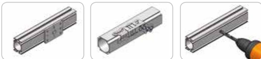
3.4. **Сверление:** в этой операции важно, чтобы отверстие было сделано по центру ровной поверхности профиля, в этом могут помочь специальные кондукторы для сверления.
