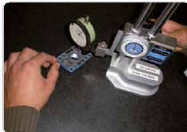
Мы предусмотрели профилактическую программу контроля и калибровки приборов. Процедуры, зарегистрированные в письменном виде, включающие способ калибровки и частоту выполнения этих операций, установлены для всех приборов, которые могут влиять на безопасность и качество выпускаемых изделий.
