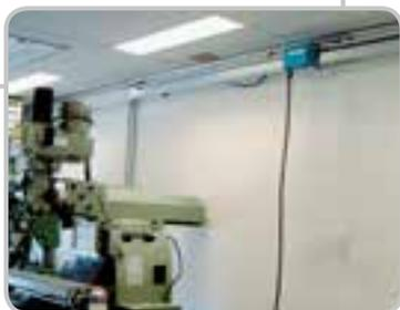
Герметизированные поворотные стрелы из алюминия для питания инструментов с широким радиусом действия.
