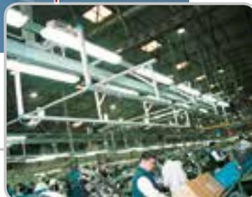
Монтажные и производственные линии, собранные с помощью алюминиевых профилей и движущихся ползунков.
