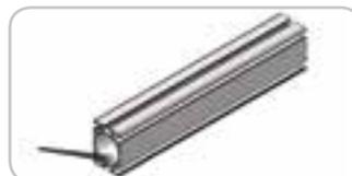
3.4. **Сверление:** в этой операции важно, чтобы отверстие было сделано по центру ровной поверхности профиля, в этом могут помочь специальные кондукторы для сверления.
