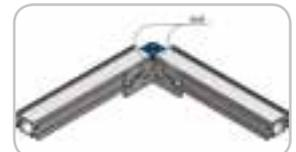
4.4. **Fixer les raccords en L et en T** au moyen des équerres prévues à cet effet. Ces dernières permettent de fixer les barres creuses des deux côtés. Pour raccorder la barre HBS25 sur sa partie étroite, arrondir l'arête sur environ 6 mm.
