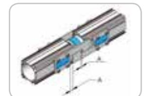
4.5. **Coulissement de la ligne** : En cas d'installation rectiligne supérieure à 50 m, prévoir un joint de recouvrement tous les 30 - 40 m. Cette précaution facilitera l'éventuel démontage des barres. Monter les deux plaques latérales au milieu de l'espace ménagé.
