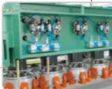
Collecteurs de distribution modulaires intégrés à machines ou lignes de production automatisées.
