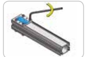
4.3. **Serrage des vis** : Effectuer cette opération avec un soin particulier. Éviter de serrer excessivement les vis afin de ne pas endommager le filet. Le couple de serrage des vis M6 est compris entre un min. de 10 N.m (91 in.Lbs) et un maximum de 13,5 N.m (120 in.Lbs).
