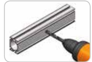
Le diamètre maximum de perçage et d'ébavurage ne doit pas être supérieur à celui conseillé dans le tableau.
