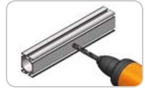
Der max. Durchmesser des Bohrloches und der Abschrägung darf den gem. Tabelle empfohlenen Durchmesser nicht überschreiten.
