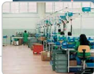
Werkbänke für Assemblerarbeiten. Ausgestattet mit Laufwagen auf Aluminiumschiene.
