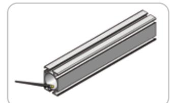
3.4 **Bohrung:** das Bohrloch muss mittig auf der glatten Oberfläche des Rohres gesetzt werden. Hilfreich ist hierfür eine Bohrschablone.
