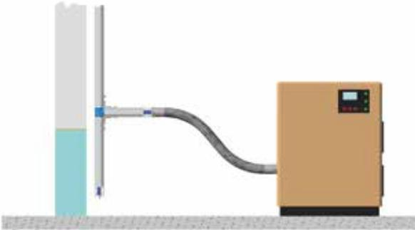
Es wird empfohlen, den Kompressor oder alle anderen Gerätetypen nur mit flexiblem Schlauch an die Anlage anzuschließen, um die Vibrationen zu dämpfen, die durch das Gerät entstehen.
