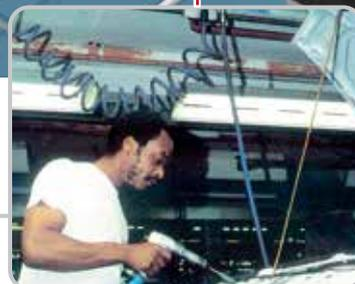
Laufwagen auf Aluminiumprofilrohr als Halterung und zur Versorgung von pneumatischen Werkzeugen.
