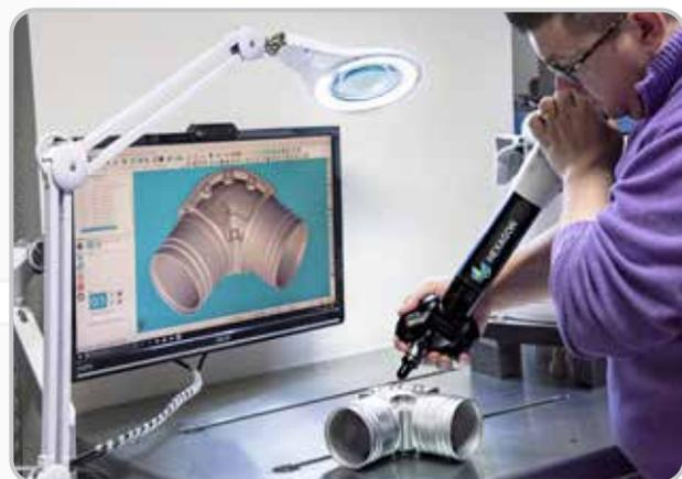
Die Teseo-Profilrohrleitungen durchlaufen 10 Funktions-, Maß- und optische Prüfungen, die während aller Produktions- und Verpackungsphasen durchgeführt werden.
