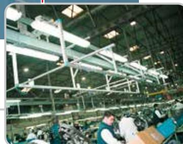
Montage- und Produktionslinien assembliert mit Aluminiumprofilrohren und Gleitblöcken.
