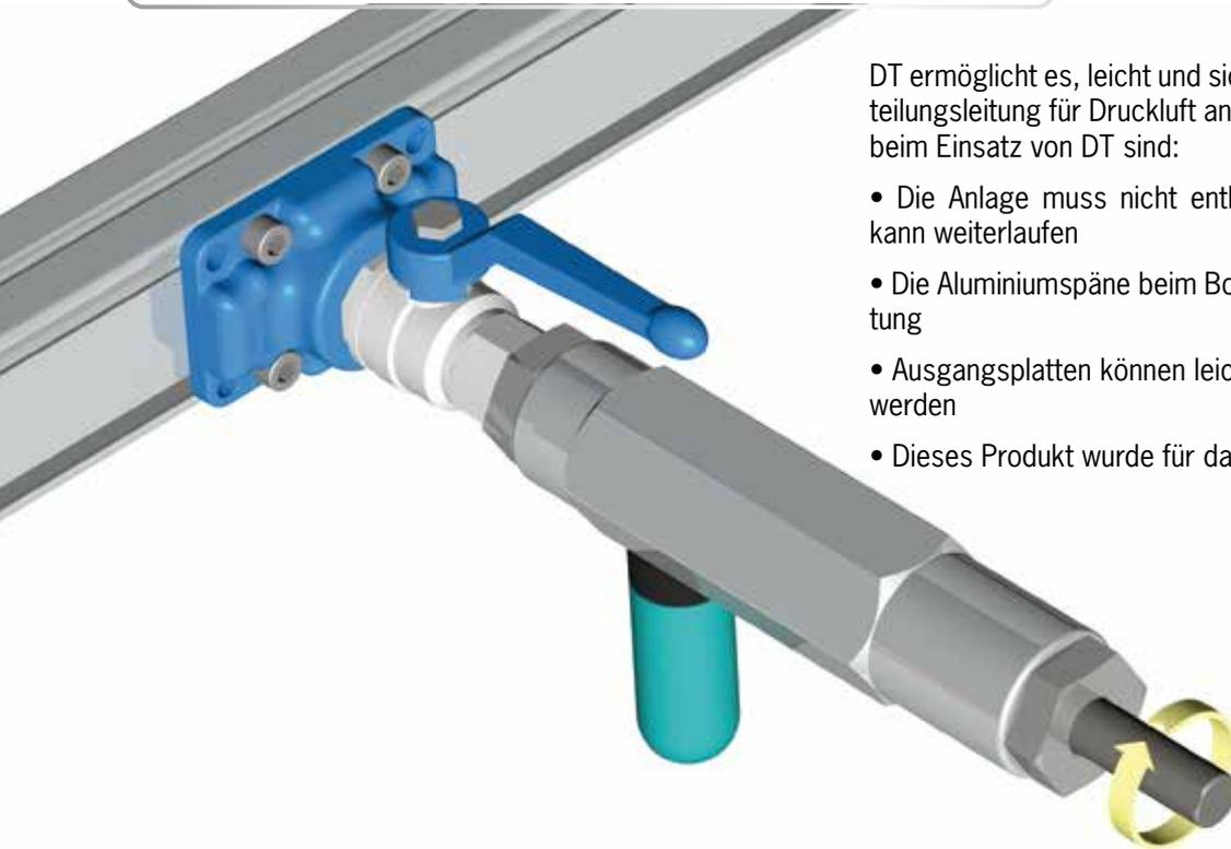
DT ermöglicht es, leicht und sicher die unter Druck stehende Verteilungsleitung für Druckluft anzubohren. Die wichtigsten Vorteile beim Einsatz von DT sind:
